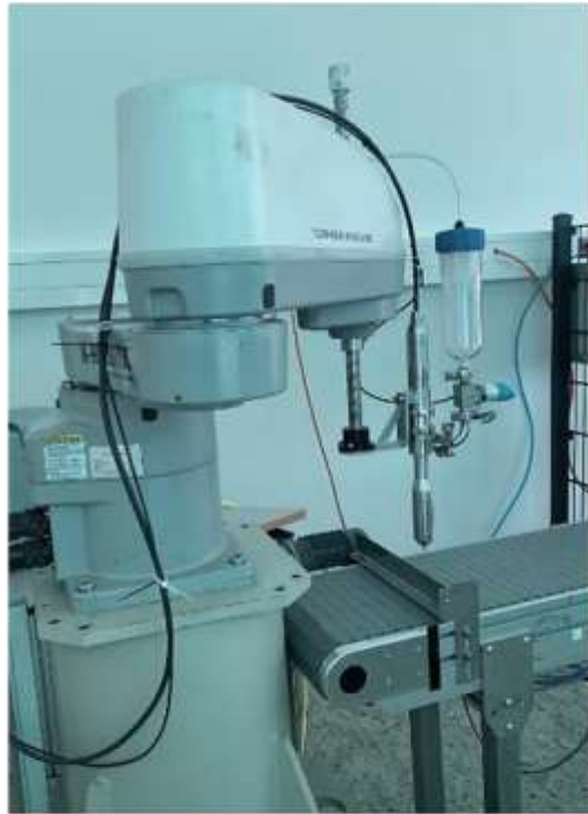
Toshiba Scara Roboter Typ: TH850 4-Achser
