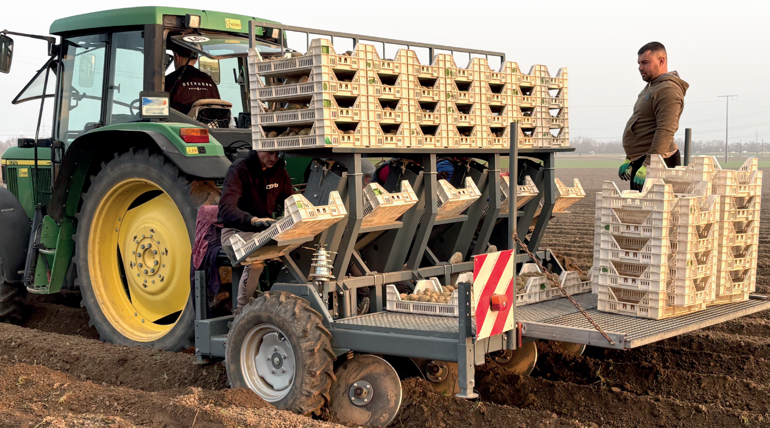
Die Pflanzmaschine für vorgekeimte Kartoffeln hat Volker Hack selbst entwickelt.
