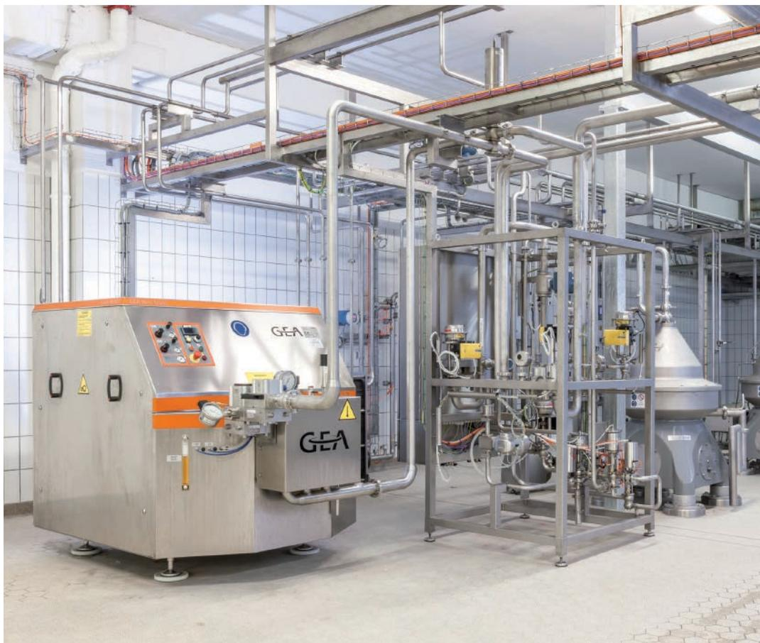
*Von links nach rechts: der Homogenisator von GEA Niro Soavi sowie von der GEA Westfalia Separator Group jeweils ein Standomat MC, ein Entrahmungs-Separator des Typs MSI 140 und für den prolong-Prozess zwei Entkeimungs-Separatoren des Typs CSI 140.*
