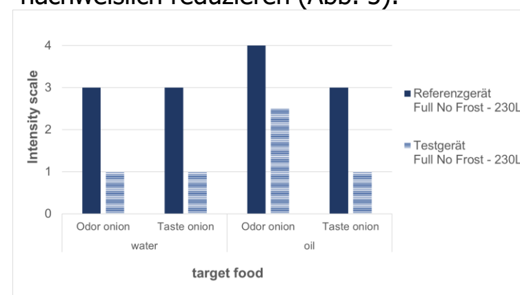
Abb. 4: Geruchsreduktionsanalyse in einem Testgerät unter Einsatz von Zwiebel als Lebensmittelquelle
