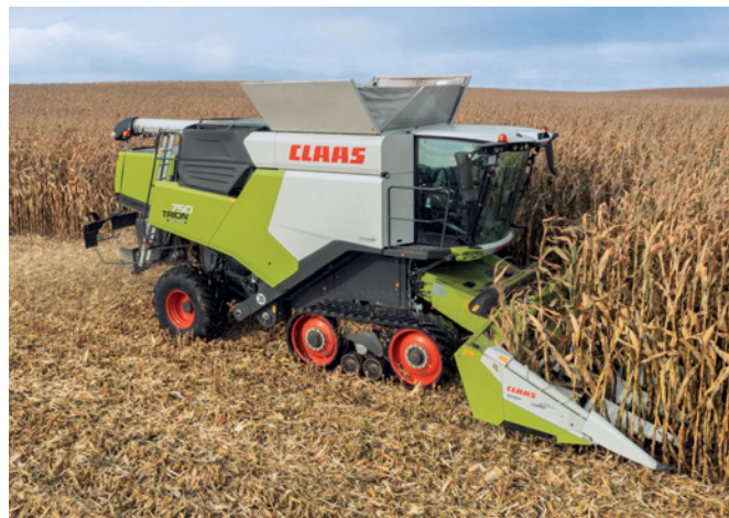
Abbildung 12: Bandlaufwerk am Mähdrescher (© Claas)
