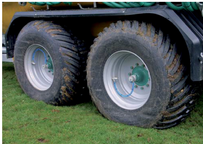
Abbildung 10: Güllefass mit Tandemachse und integrierter Reifennendruckverstellung (© LfL)
