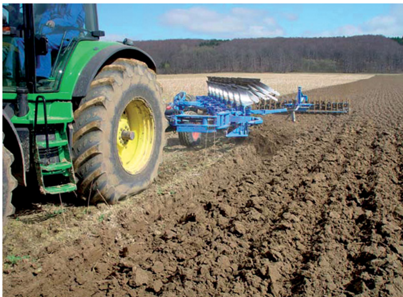
Abbildung 6: On-Land-Pflügen mit abgesenktem Reifeninnendruck (© Lemken)
