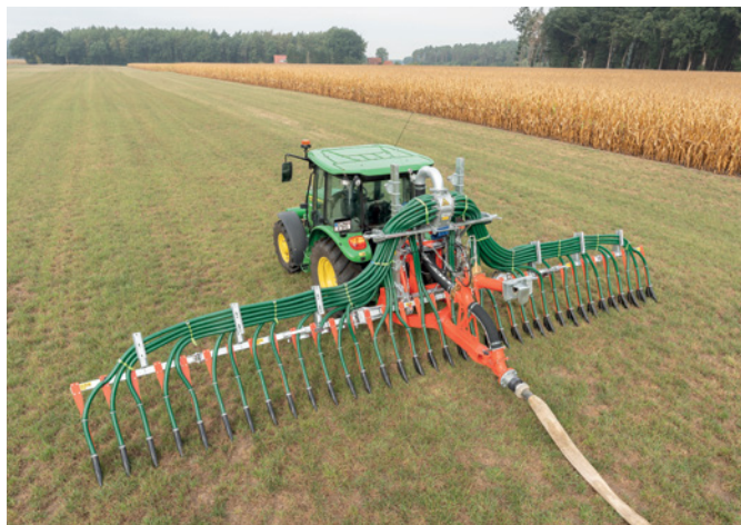
Abbildung 9: Gülleverschlauung als bodenschonendste Ausbringtechnik (© Vogelsang)
