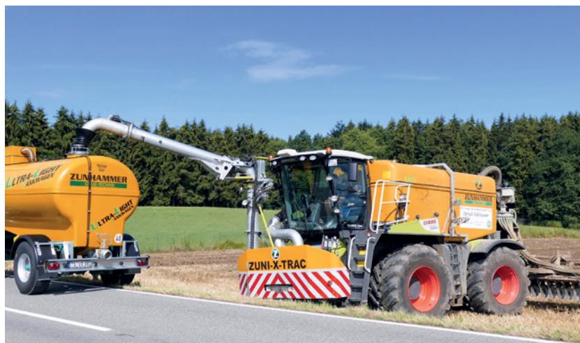
Abbildung 8: Trennung von Straßentransport und Ausbringung der Gülle mit Ausbringfahrzeug (© Zunhammer)
