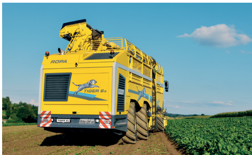
Abbildung 14: Verteilung der Lasten auf 3 Achsen (© Ropa)
