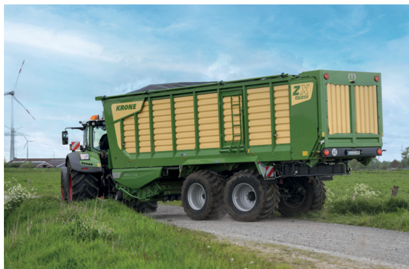
Abbildung 13: Großvolumig bereifter Transportanhänger für Häckselgut (© Krone)
