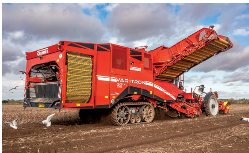
Abbildung 15: Bandlaufwerk am Roder (© Grimme)
