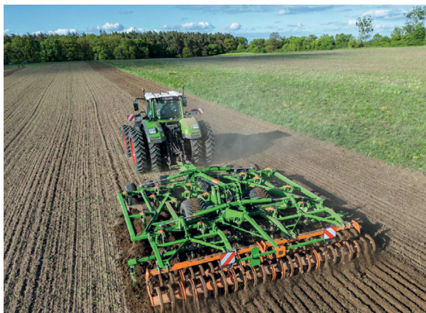
Abbildung 7: Bodenbearbeitung mit Zwillingsreifen und aufgesatteltem Gerät (© Amazone)
