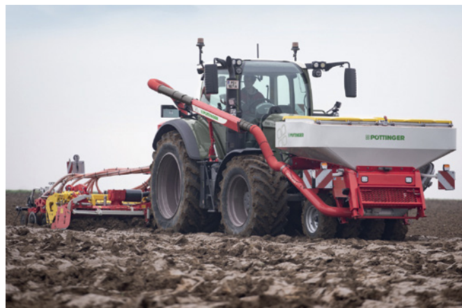
Abbildung 11: Pneumatische Fronttankdrillmaschine in Kombination mit einer Kreiselegge (© Pöttinger)
