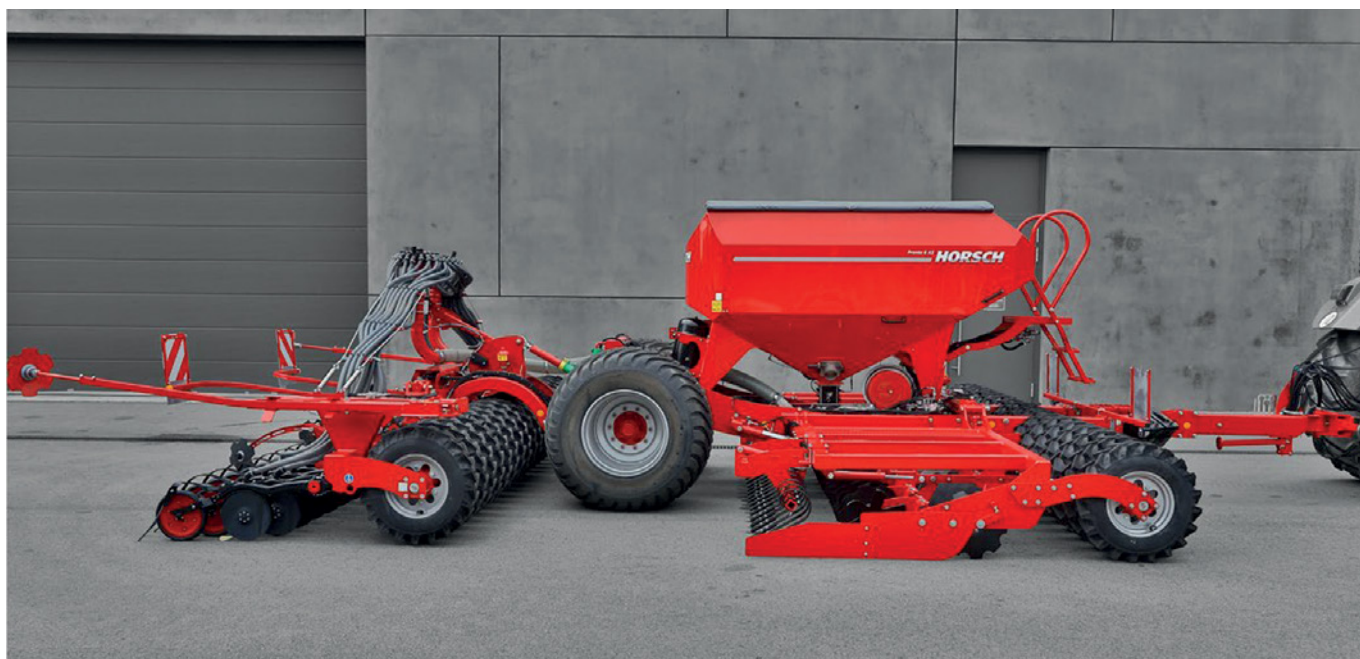
Abbildung 33: Säkombination mit Kurzscheibenegge und aufgebauter pneumatischer Drillmaschine (© Horsch)
