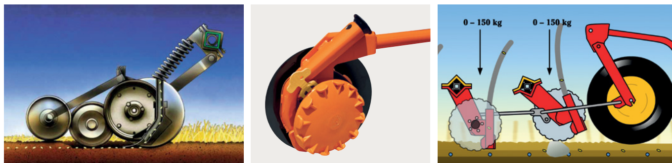
Abbildung 20: Tiefenführung bei Scheibensäscharen (v. l. n. r.): seitliche Tiefenführungsrolle (© John Deere), integrierte Tiefenführungsrolle (© Amazonen-Werke), nachlaufende Packerräder (© Väderstad)
