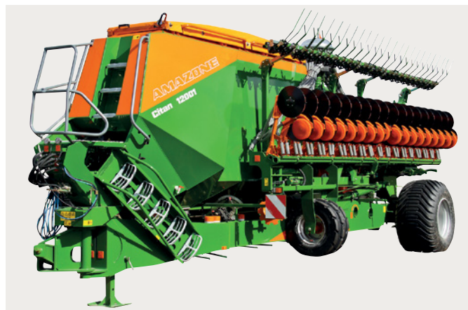
Abbildung 10: Pneumatische Drillmaschine mit 12 m Arbeitsbreite in Transportstellung (© Amazonen-Werke)
