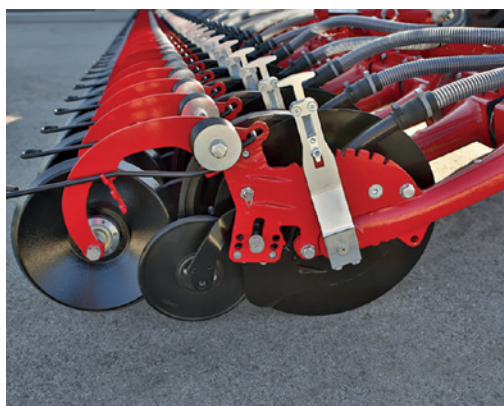
Abbildung 22: Andruckrollen (v.l.n.r.): Zwischenandruckrollen und gefedert angebrachte einstellbare Druckrollen (© Horsch); Bedeckungsrolle an schwerem Direktsaat-Scheibensäschar (© John Deere); Rollenstriegel (© Amazonen-Werke)
