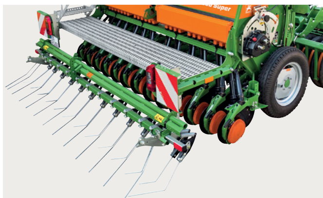
Abbildung 21: Saatstriegel: gekröpfte, leichtere Ausführung (links, © Amazonen-Werke); gerade, schwere Ausführung (rechts, © Horsch)
