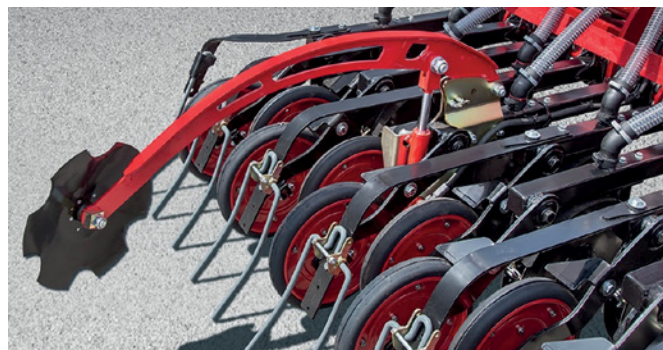
Abbildung 29: Vorauslaufmarkierer mit hydraulischer Betätigung (© Horsch)
