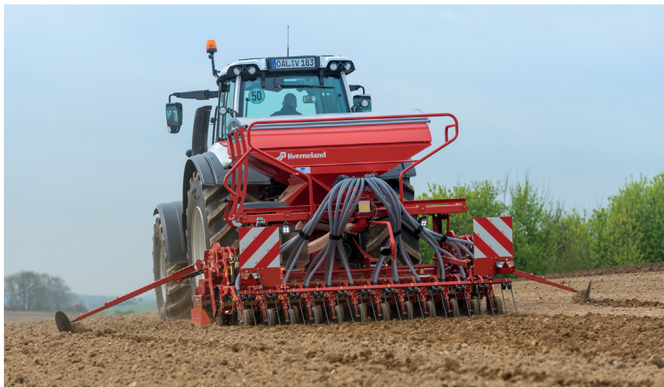
Abbildung 26: Säkombination mit beidseitig abgesenkten Spuranreißerarmen (© Kverneland)
