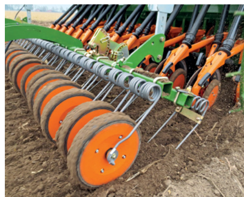
Abbildung 22: Andruckrollen (v.l.n.r.): Zwischenandruckrollen und gefedert angebrachte einstellbare Druckrollen (© Horsch); Bedeckungsrolle an schwerem Direktsaat-Scheibensäschar (© John Deere); Rollenstriegel (© Amazonen-Werke)
