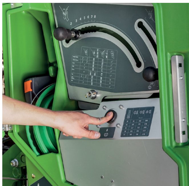
Abbildung 24: Einstellcenter einer mechanischen Drillmaschine (© Amazonen-Werke)
