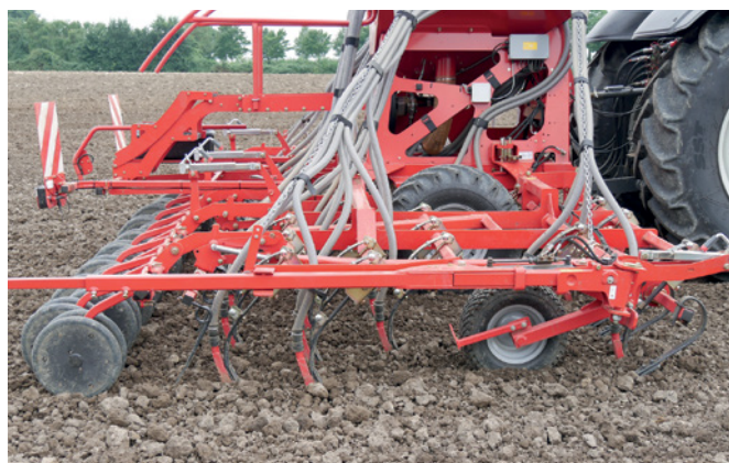
Abbildung 16: Drillmaschine mit leichten Zinkensäscharen in fünfreihiger Anordnung (© Kverneland)
