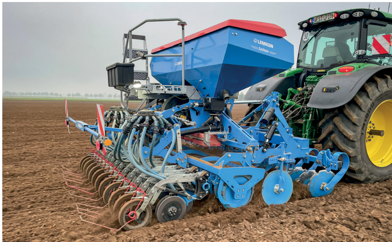
Abbildung 32: Säkombination mit Kurzscheibenegge und aufgebauter pneumatischer Drillmaschine (© Lemken)
