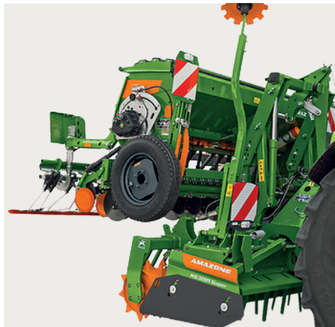
Abbildung 31: Transportstellung einer mechanischen Drillmaschine in einer Kreiseleggenkombination mittels hydraulischem Hubrahmen (© Amazonen-Werke)
