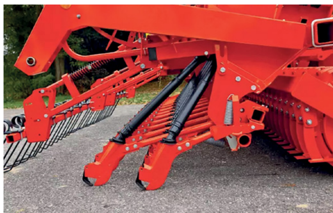
Abbildung 14: Zweireihige Säscharanordnung (© Kuhn)
