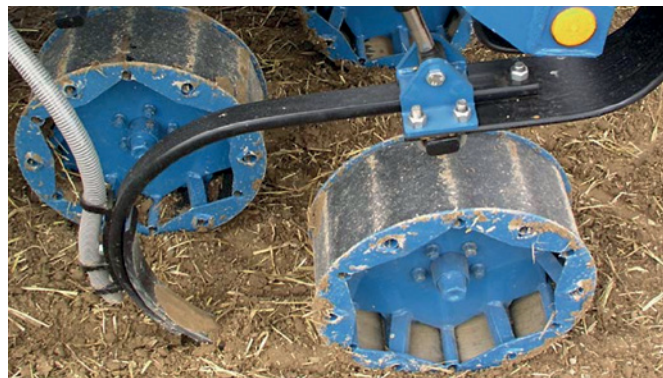
Abbildung 17: Zinkensäschar für Bandsaat (© Köckerling)
