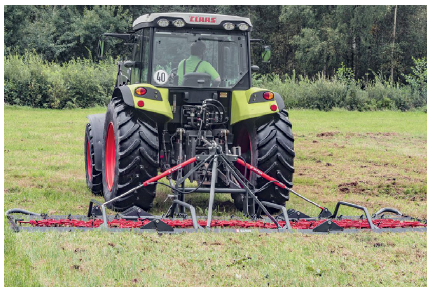
Abbildung 13: Wiesenschlepppe im Einsatz (© Saphir Maschinenbau GmbH)
