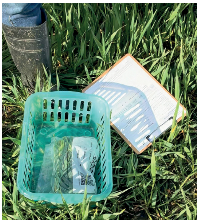
Abbildung 6: Richtige Probenahme und -handhabung von Pflanzenmaterial umfasst das Verpacken in gelochte Beutel (links), ausreichende Mischprobenmenge, eindeutige Kennzeichnung mit allen relevanten Angaben sowie eine kühle Lagerung (rechts) und schnellen Versand ins Labor (© C. Harwardt)
