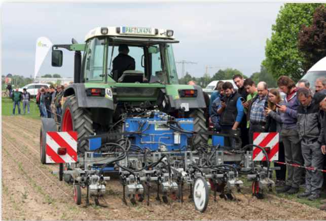
Abbildung 18: Robovator: Die Werkzeuge regulieren Unkräuter in der Reihe (Foto: B. Vinzent, LfL Bayern)
