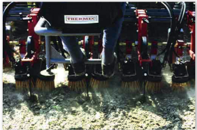
Abbildung 10: Tellerhackbürsten bekämpfen Unkräuter durch verschütten (Foto: Dr. Kolbe)
