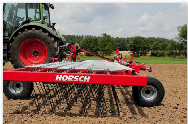
Abbildung 3: Striegelsysteme sind aufgrund parallelogrammgeführter Hebelsysteme an den jeweiligen Standort anpassungsfähig (Foto: Horsch Maschinen GmbH)
