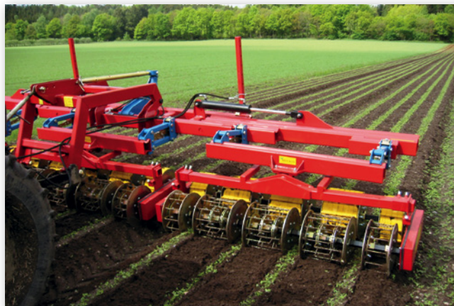
Abbildung 8: Bügelhacken lockern im ersten Schritt den Boden und ziehen Unkräuter aus dem Boden heraus (Foto: Kress Umweltschonende Landtechnik GmbH)
