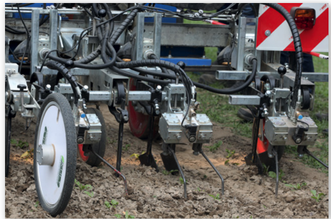
Abbildung 19: Robovator: Kameras steuern die Werkzeuge (Foto: B. Vinzent, LfL Bayern)
