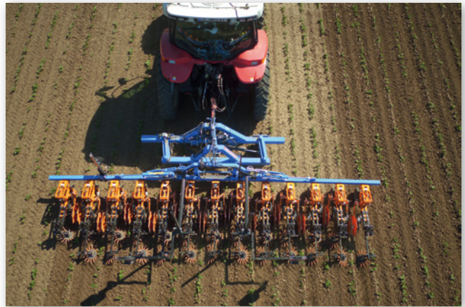
Abbildung 4: Scharhacken eignen sich zur Unkrautbekämpfung in unterschiedlichen Wachstumsstadien (Foto: Schmotzer Hacktechnik GmbH)
