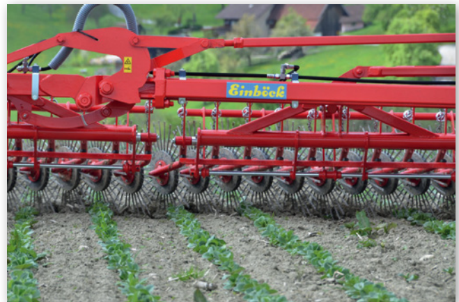
Abbildung 16: Anstellwinkel, Fahrgeschwindigkeit, Zinkenzahl und Sterndurchmesser bestimmen die Arbeitsqualität des Rollstriegels (Foto: Einböck)
