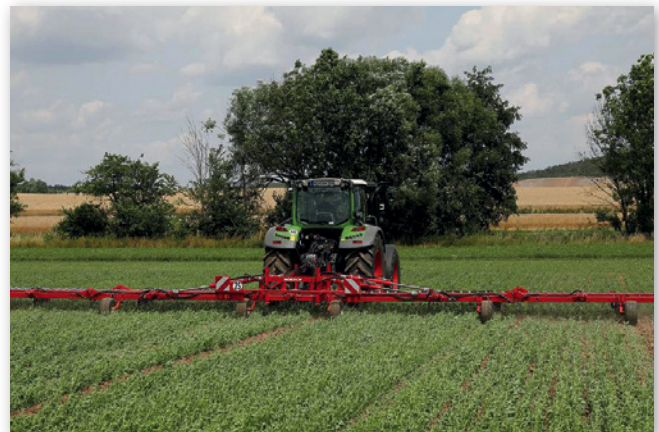
Abbildung 2: Zinkenstriegel eignen sich für den ganzflächigen Einsatz (Foto: Horsch Maschinen GmbH)
