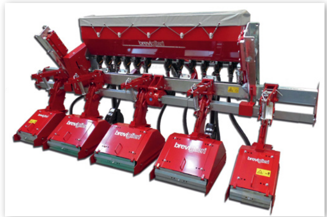
Abbildung 11: Fräsen für Reihenkulturen zeichnen sich durch intensive Zerkleinerungswirkung aus und erreichen eine gute Unkrautregulierung (Foto: breviglieri)
