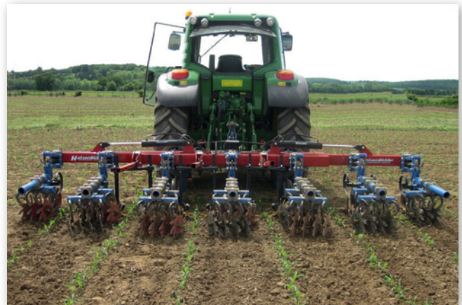
Abbildung 6: Rollhacken sind ganzflächig und im Zwischenreihenbereich einsetzbar (Foto: Thomas Hatzenbichler Agro-Technik GmbH)
