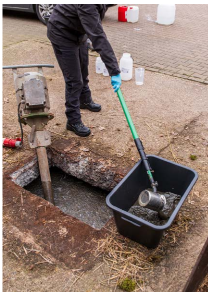
Entnahme einer Teilprobe mit der Teleskopstange aus einer Vorgrube
