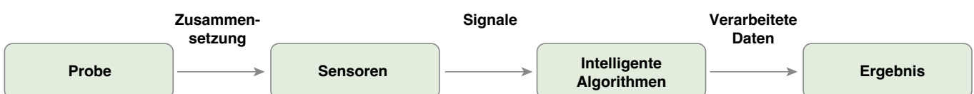
Abbildung 4: System der e-Nase [eigene Darstellung nach Mavani et al. 2022]
