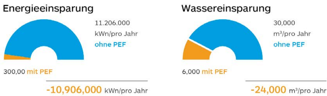
Abbildung 2: Fallbeispiel: 26 t/h Rohmaterial einer Pommes-Frites-Linie, 7.700 Produktionsstunden pro Jahr.
