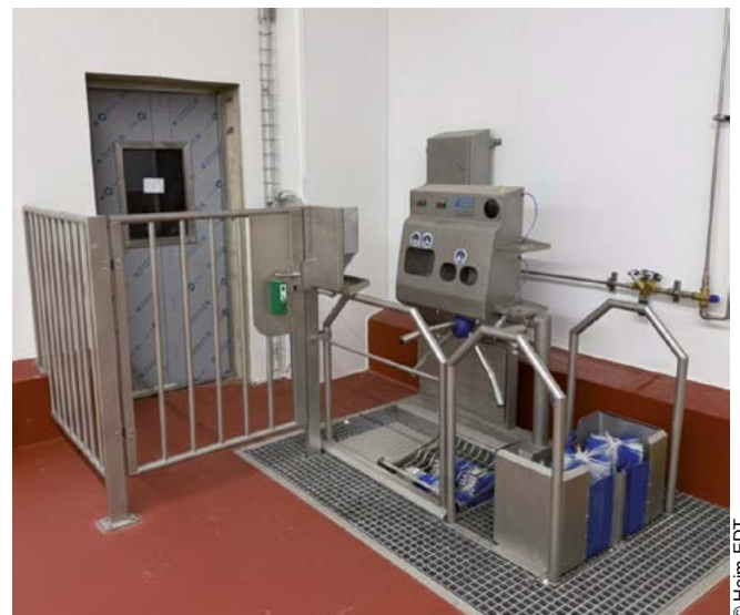
Hygieneschleuse mit Fluchttür und Schafftreinigung von Heim-EDT.
