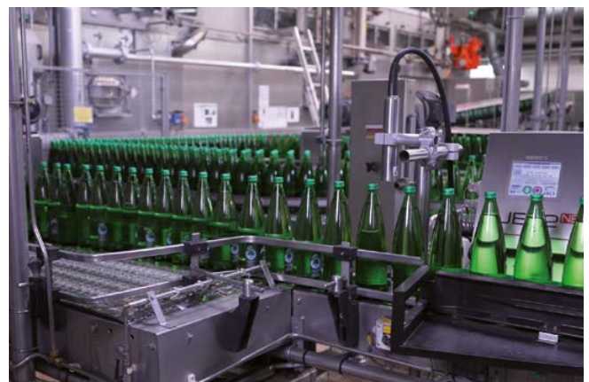
Bei voller Kapazität laufen bis zu 15.000 Flaschen pro Stunde und bis zu eine Million Flaschen pro Tag vom Band.
