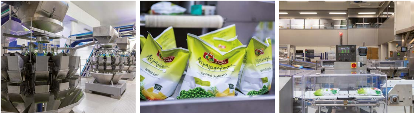
Sechs Mehrkopfwagen und vier Kontrollwagen verarbeiten Tiefkühlgemüse, Gemüse- und Reismischungen sowie Pasta in Verpackungsgrößen von 300 Gramm bis zehn Kilogramm.
