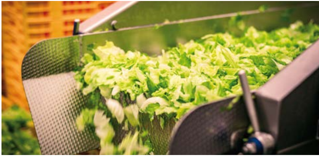
Für das angelieferte Frischgemüse nutzt Pierre Baguette eine eigene Gemüsewaschanlage mit UVC-Tauchstrahler zur Wasserentkeimung.
