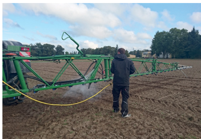
Abbildung 5: Reinigung der Pflanzenschutzspritze auf dem Feld (links) sowie die dafür entsprechenden Einstellungen der Wasserzufuhr (rechts). Für eine gute Reinigungsleistung ist ausreichend Wasser in Verbindung mit hohem Druck notwendig (© M. Glaser, LTZ Augustenberg)
