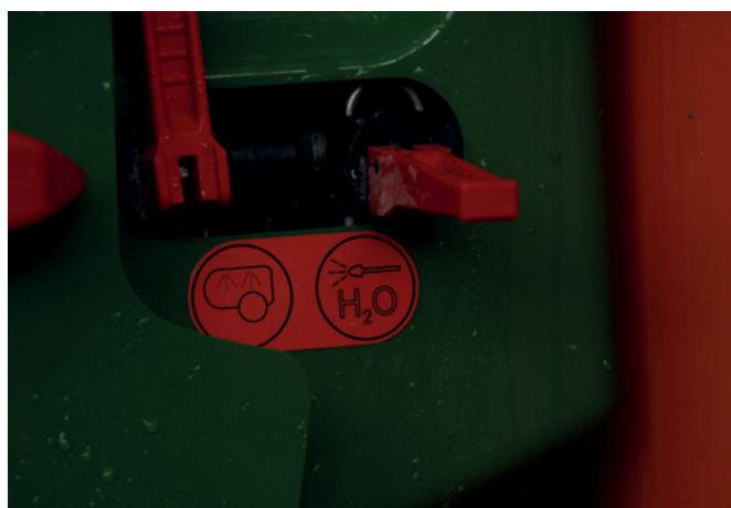
Abbildung 5: Reinigung der Pflanzenschutzspritze auf dem Feld (links) sowie die dafür entsprechenden Einstellungen der Wasserzufuhr (rechts). Für eine gute Reinigungsleistung ist ausreichend Wasser in Verbindung mit hohem Druck notwendig (© M. Glaser, LTZ Augustenberg)
