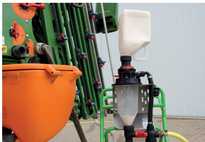
Abbildung 4: Kontaminationsfreies Befüllsystem für Kleingebinde mit integrierter Kanister-Spülmöglichkeit (EasyFlow) (© M. Glaser, LTZ Augustenberg)
