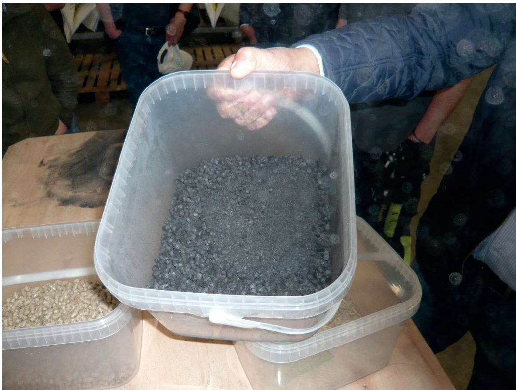
Abb. 3: Biokohle hergestellt aus der Pyrolyseanlage
