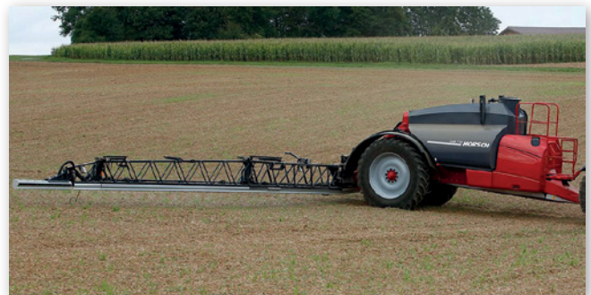
Abbildung 2: Spritzbrühebehälter aus Edelstahl (Quelle: Horsch)
