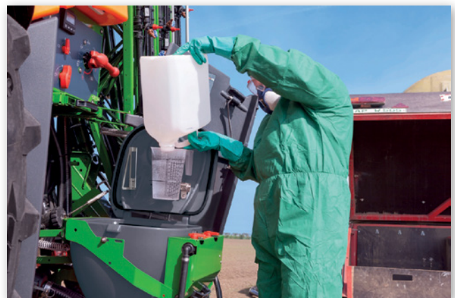
Abbildung 3: Einspülschleuse aus PE (Quelle: Amazone)
