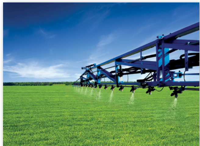
Abbildung 14: Düsen mit Pulsweitenmodulation beim Einsatz (Quelle: TeeJet)
