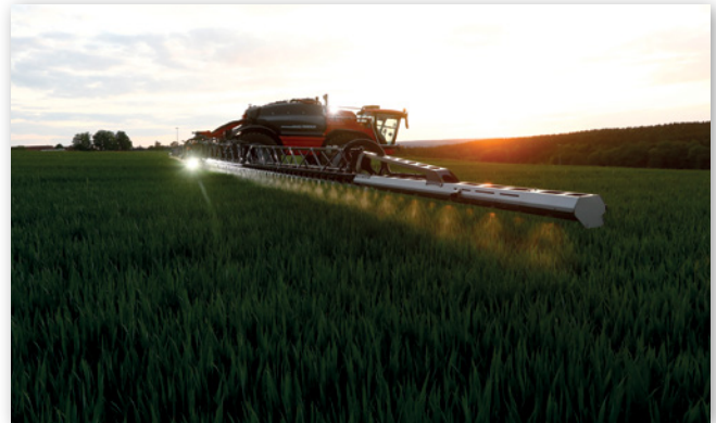
Abbildung 11: Beleuchtetes Gestänge mit Doppelflachstrahldüse (Quelle: Horsch)
