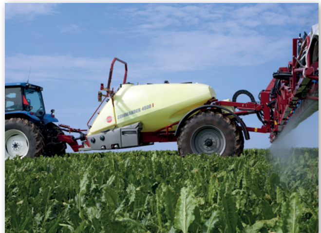
Abbildung 10: Spritzgestänge mit Luftunterstützung, System Hardi Twin Force (Quelle: Hardi)
