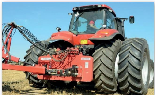
Abbildung 26: Heckgewicht der Firma Grasdorf
