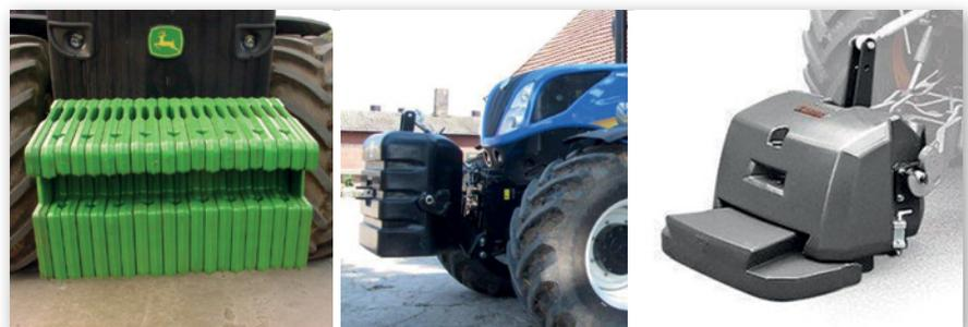
Abbildung 25: Frontgewichte, links: Koffergewichte, mitte: „klassisches“ Frontgewicht in der Fronthydraulik, rechts: Frontgewicht mit Schnellwechsel-Gewichtsplatte (Quelle: Uppenkamp, Werkbild Claas)
