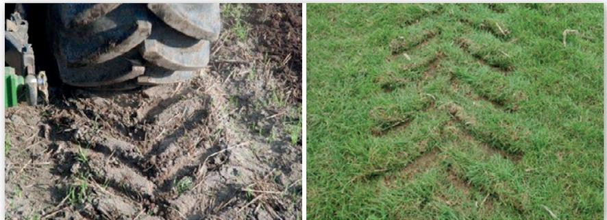
Abbildung 4: Das Spurbild zeigt hohen Schlupf von 20%; die Erdblocke aus den Stollenzwischenräumen sind verschoben, die Grasnarbe abgeschert (Quelle: Volk)
