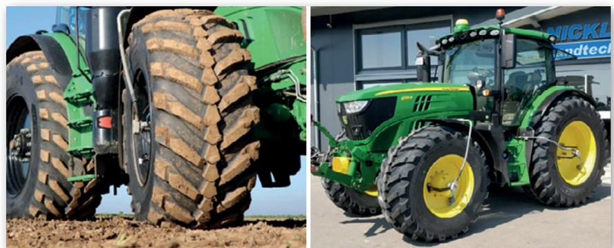
Abbildung 20: Für den Einsatz in Kombination mit einer Reifendruckregelanlage konzipierter Reifen „EVOBIB“ der Firma Michelin (Foto: Michelin)
