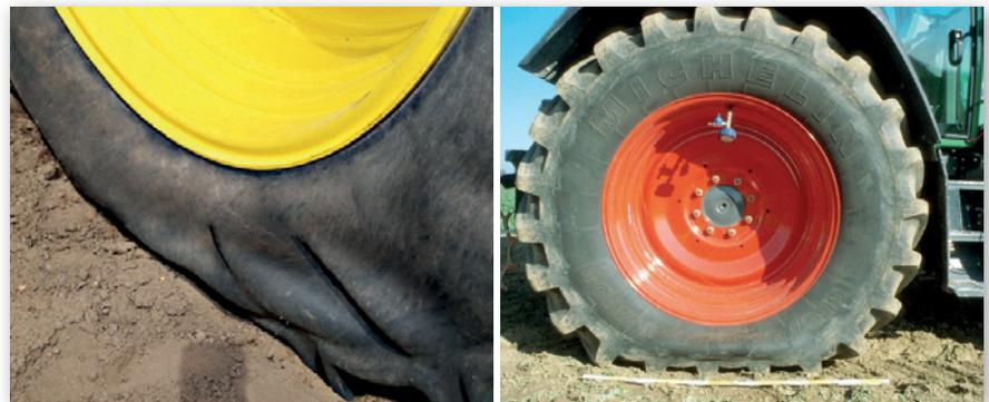
Abbildung 16: links: So sollte der Reifen bei der Zugkraftübertragung nicht aussehen. Bei einer derartigen Faltenbildung sind Reifenschäden nicht auszuschließen. (Quelle: Weißbach); rechts: Bei geringer Zugkraft schadet dagegen eine starke Einfederung nicht (Quelle: Volk)
