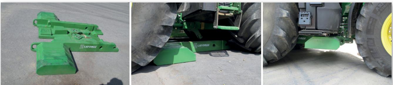
Abbildung 27: Zwischenachsgewicht „EZ-Ballast“: Die Gewichtsplatte (links) wird mit der Vorderachse des Traktors überfahren (mitte) und mit dem Hubrahmen am Traktor hydraulisch angehoben und verriegelt (Quelle: Uppenkamp)
