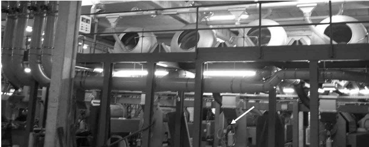
Abb. 2: Gesamtanlage. Unten: Trockner zur Aufnahme feuchtem Mantelsaatgut mit Entnahmeeinrichtung zur Kontrolle des Trocknungsprozesses (s. Pfeil). Oben: Dragiertrummeln .
