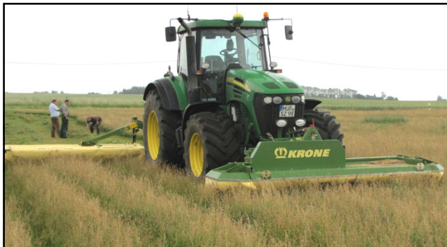
Krone Easy Cut Front und Heckanbau Arbeitsbreite 6,50 m
