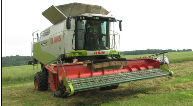
Schwadaufnahme DZ 6.20 Arbeitsbreite 6,20 m
